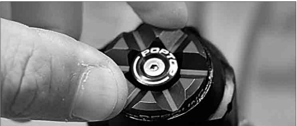
**FAITES TOURNER LA MOLETTE DANS LE SENS “-” (SENS CONTRAIRE AUX AIGUILLES D’UNE MONTRE) POUR AUGMENTER LA VITESSE DE DÉTENTE (PLUS RAPIDE).**
